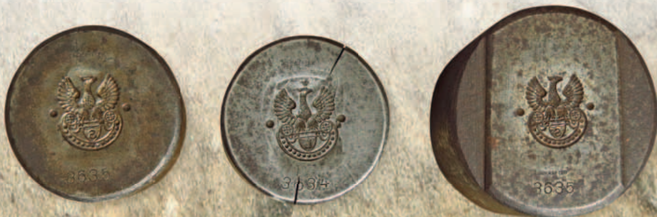
▶ Matryce do produkcji miniaturowych orłów; widoczna sygnatura „SCHÖFFLER”
