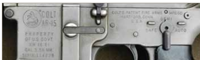
▶ Sygnatury na komorze zamkowej, m.in. nazwa producenta (Colt), wersja (XM16E1), kaliber (5,56 mm) oraz numer seryjny
